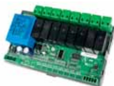
MÓDULO DE CONTROL DE ELEMENTOS RADIANTES
