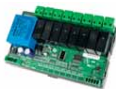
MÓDULO DE CONTROL DE ELEMENTOS RADIANTES
