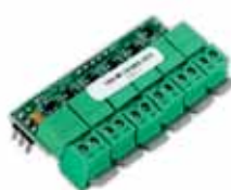
MÓDULO ON / OFF DE ZONA
