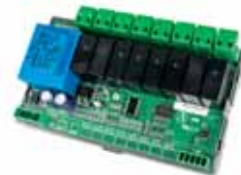
MÓDULO DE CONTROL DE ELEMENTOS RADIANTES
